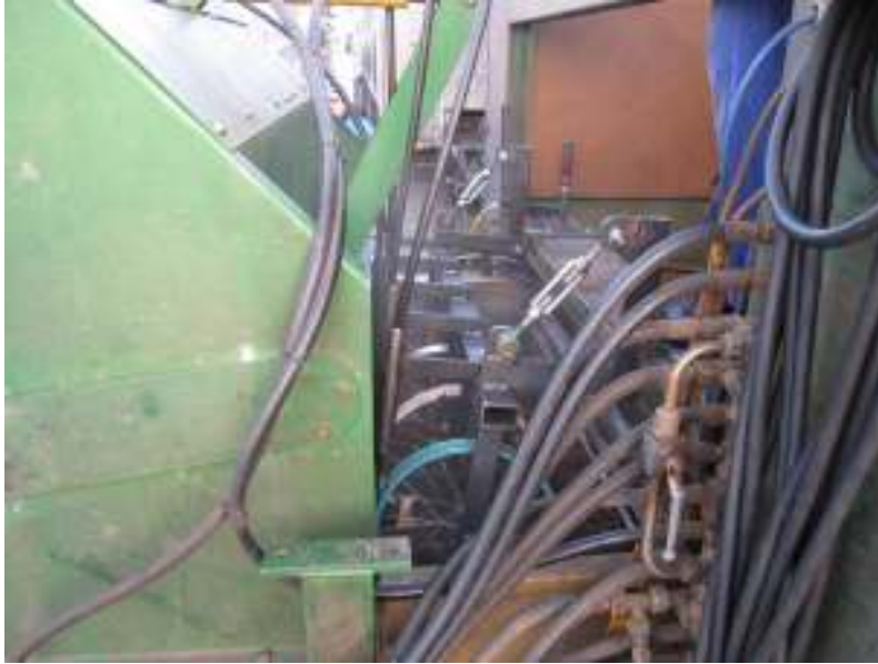
Figuur 2. Met de kopvulmachine zijn 5 druppelslangen tijdens het vullen bovenin de compost aangebracht.
